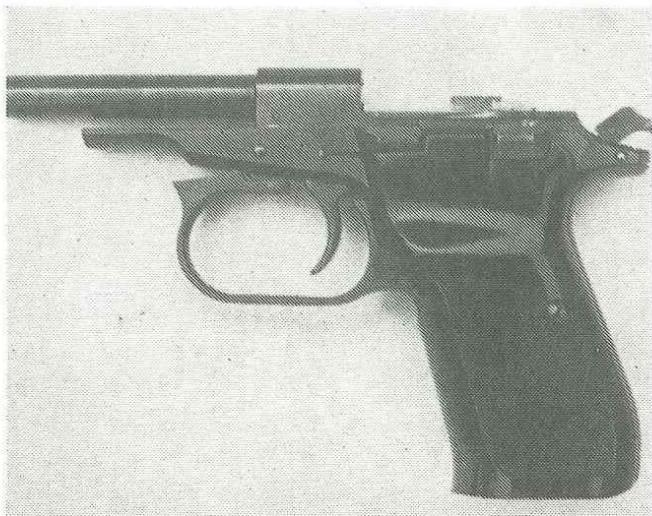
vyklopí směrem nahoru. Pak lze závěr vysunout dopředu ze zbraně. Ze závěru se volně vyjme vrataň vzpruha. Skládání pistole se provádí obráceným způsobem. Při nezaklopeném lučíku nelze zásobník zasunout úplně do zbraně.
